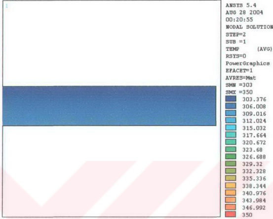
Şekil 4.2: Düz Kanalda Sıcaklık Dağılımı ( T_s = 303 K, Re = 500 )
