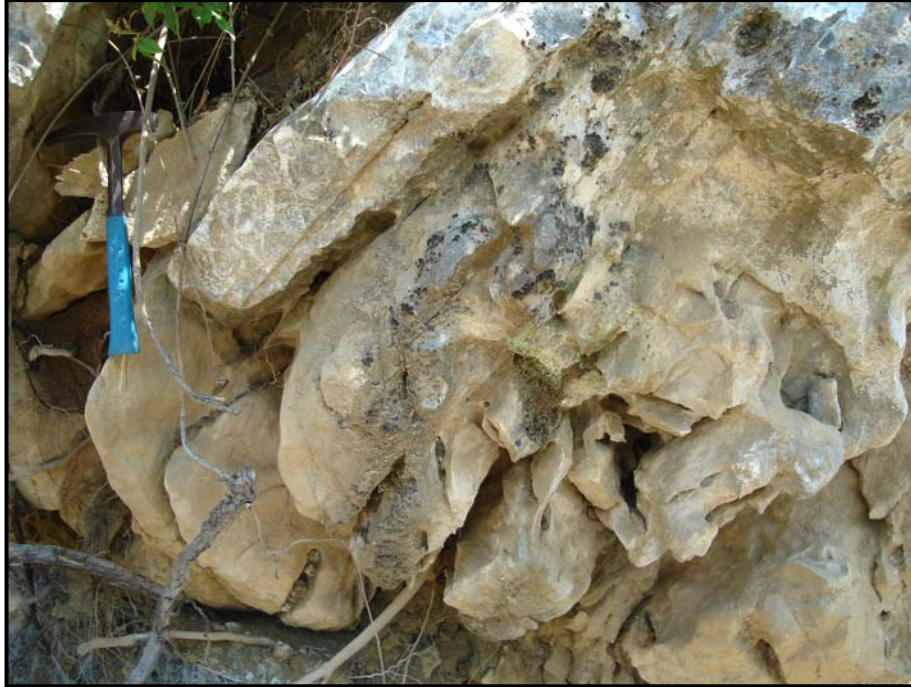
Şekil 2.24. Kireçtaşı bloğunda gözlenen karstik boşluklar
