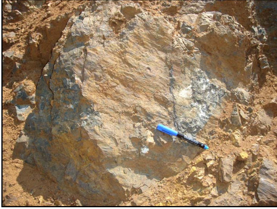
Şekil 2.34. Karapınar Sirtının kuzeydoğusundaki yol yarmasında, metabazitte gözlenen fay çizikleri, GB'dan KD'ya bakış (Koordinat: 18927/41309)
