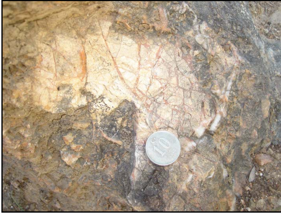
Şekil 2.36. Kireçtaşı parçalarından oluşan breşik yapı (Koordinat: 22230–36010)
