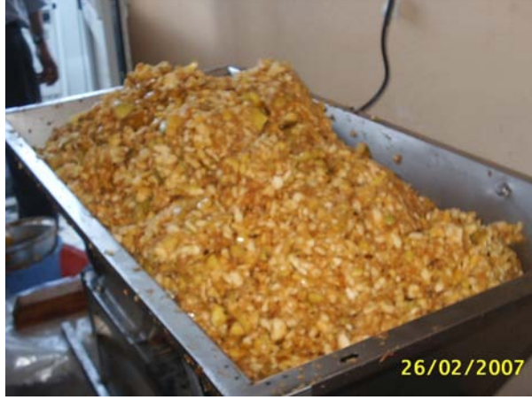
Şekil 4.6. Elma parçacıklarının parçalama makinesi haznesindeki görünüşü.
