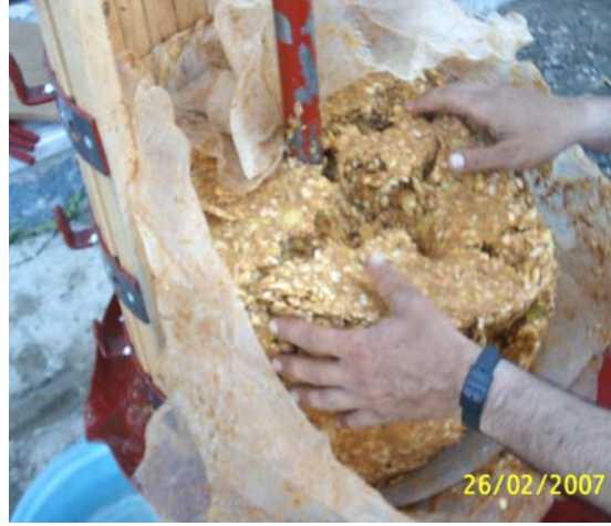
Şekil 4.8. Presleme işlemi sonunda posanın çıkarılması.
