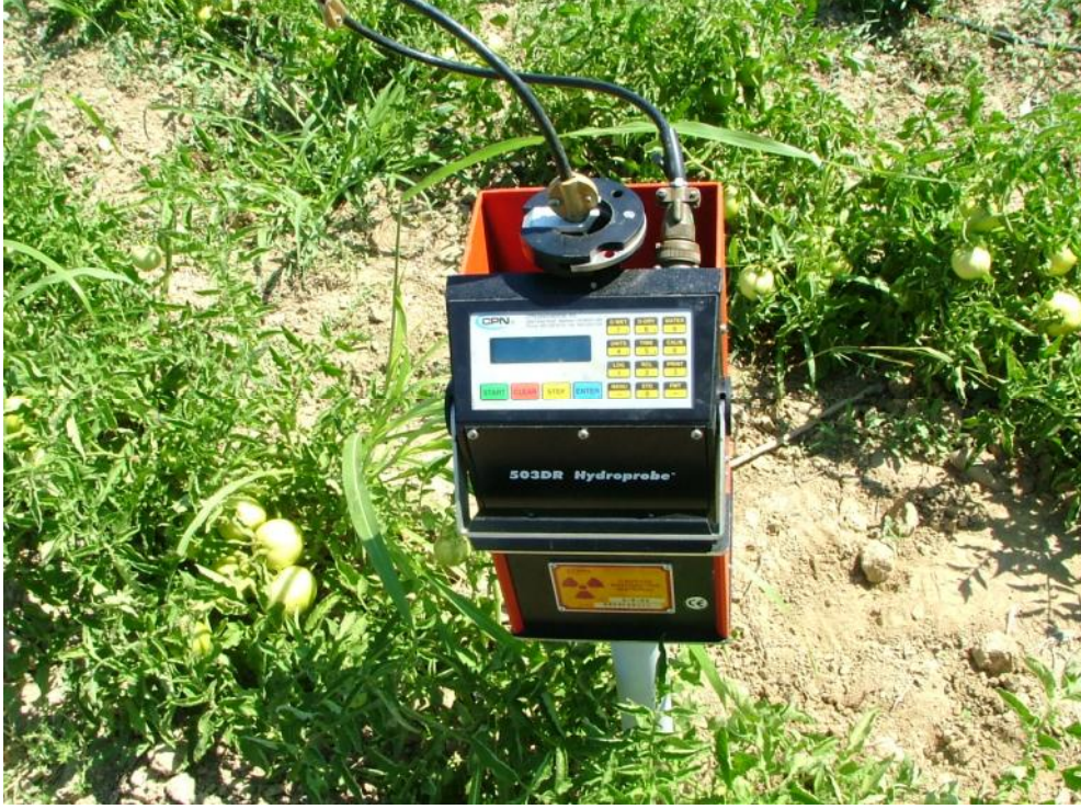
ekil 3.4. Denemede kullanılan Nötron Probe
