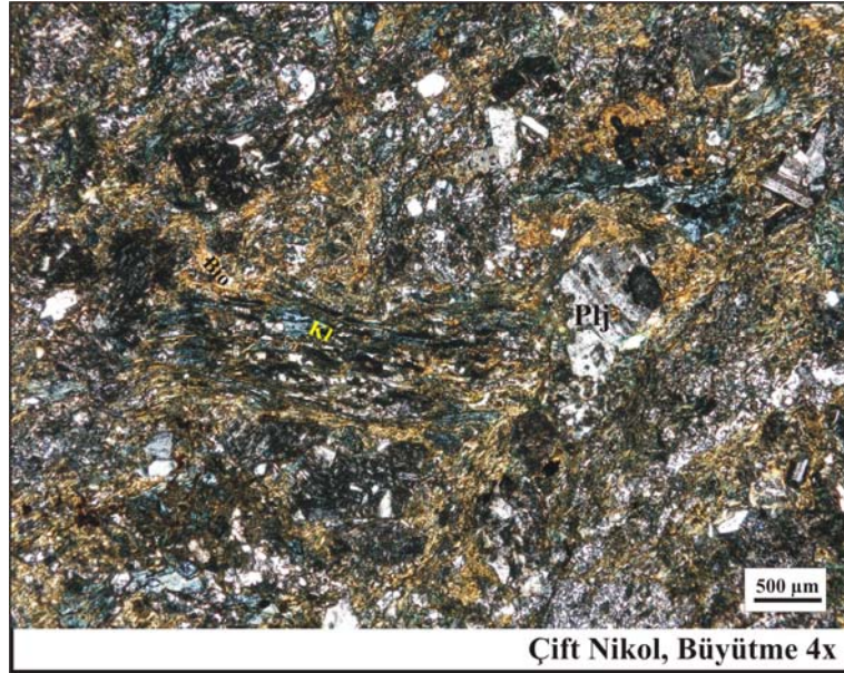
Şekil 3.21. Metabazitin mikroskop altındaki görünümü (Bio: Biyotit, Kl: Klorit, Plj: Plajioklas)
