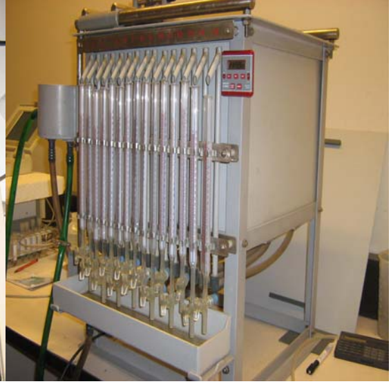
Resim 3. Hidrolik iletkenlik (kf) belirlenmesi (Hidrolik İletkenlik Cihazı)
