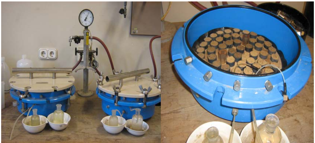
Resim 4. pF 4,2 Belirlenmesi (Toprak Su Ekstraksiyon Cihazı, 15 bar basınç)
