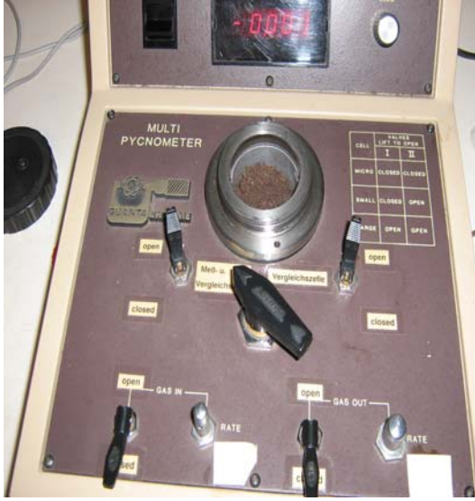
Resim 2. Tane yoğunluğu (df) belirlenmesi (Helyum Piknometre Cihazı)
