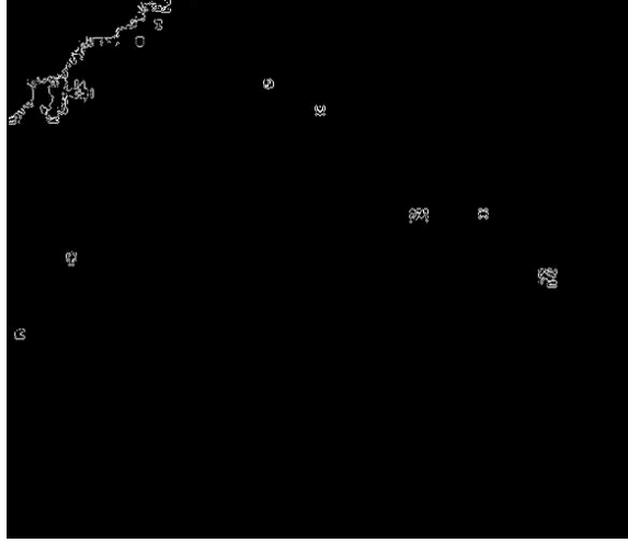
Şekil 5.15. Kenar belirleme algoritması ile üzerindeki nesnelerin sınırları belirlenen yakınlaştırılmış seramik karo görüntüsü.
