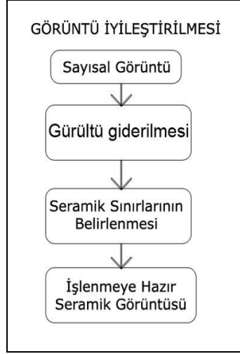
Şekil 5.8. Görüntü iyileştirme adımları.
