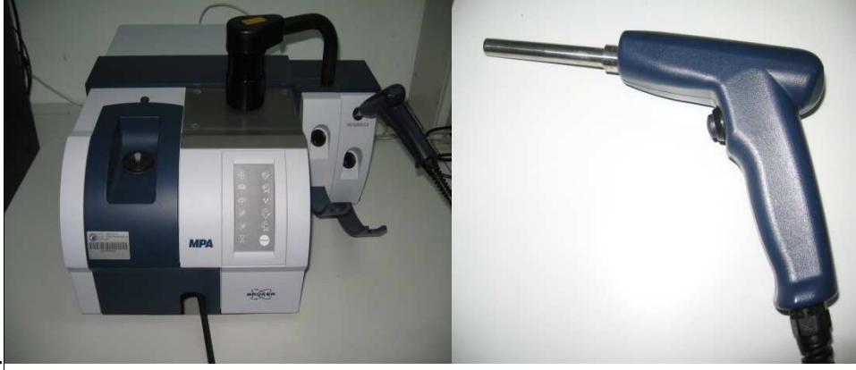
Şekil 3.6. FT-NIR spektrometre ve fiber optik algılayıcı
