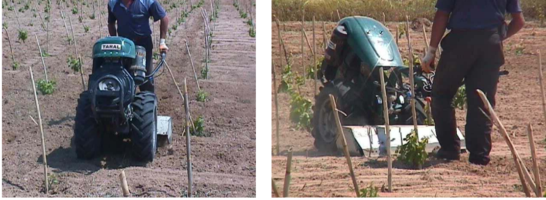
Şekil 3.8. Dar sıra özelliğine sahip goble tipi bağların toprak işleminde kullanılan bahçe tipi el frezesi
