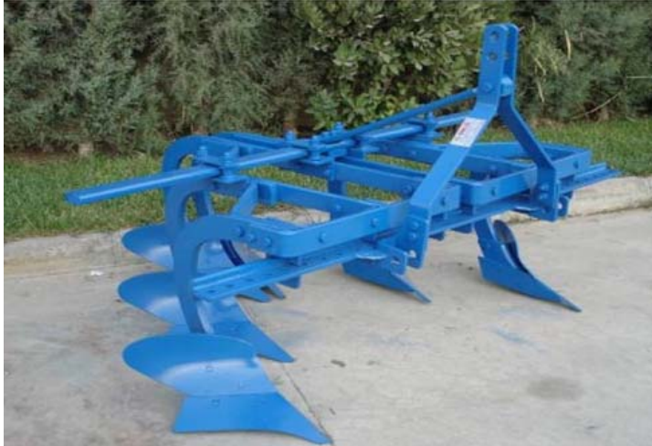
Şekil 3.9. Traktörle çekilen ve yüksek telli geniş sıralı bağların toprak işleminde kullanılan kulaklı pulluk
