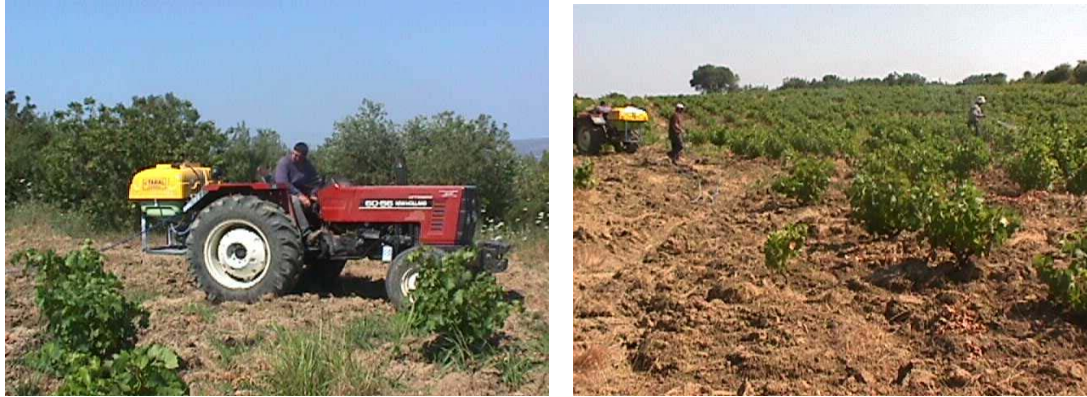
Şekil 3.11. Traktörle çekilen ve yüksek telli geniş sıralı bağların ilaçlanmasında kullanılan pülverizatör
