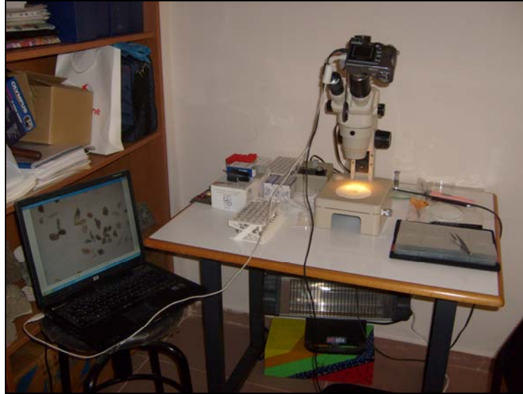
Şekil 3.23. İmaj analizi yöntemi kullanılarak minerallerin tanımlama işlemi.
