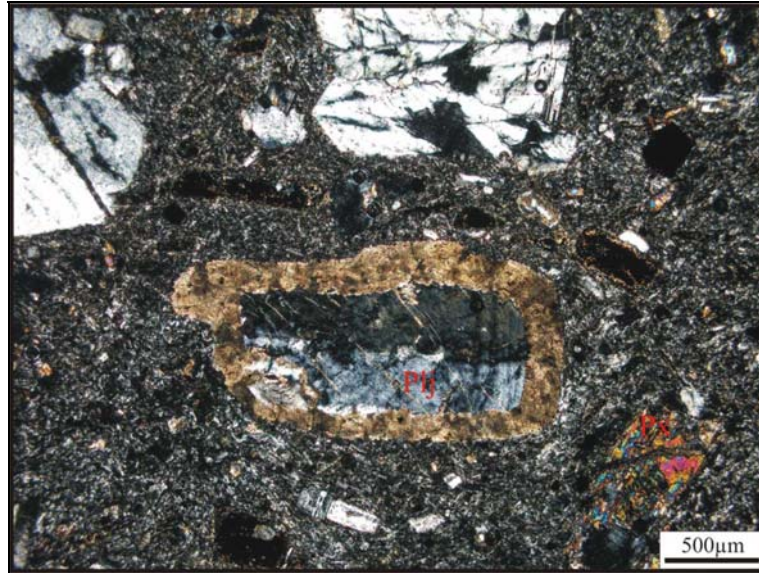
Şekil 4.35. Trakibazalt örneğinde plajyoklası çevrelemiş serizit mineralleri. Plj; plajyoklas, Px; Piroksen.
