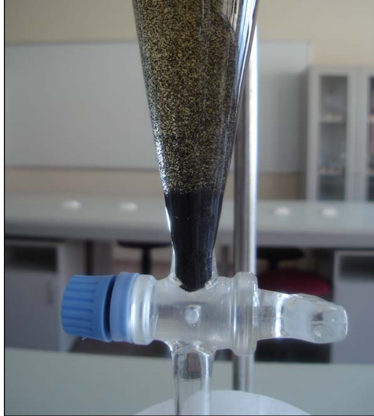
Şekil 3.18. Ağır mineral ayırma işleminde SPT içinde çökelmiş ağır mineraller.
