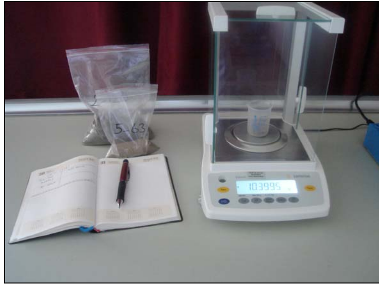
Şekil 3.14. Ağır mineral analizinde saf su ile yıkanıp kurutulmuş, analize hazırlanmış bir örnek.
