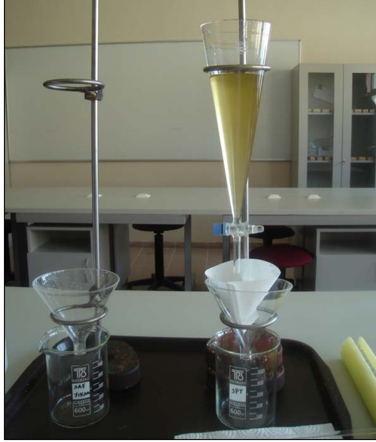
Şekil 3.15. Ağır mineralleri ayırma işleminde kullanılan ayırma düzeneği
