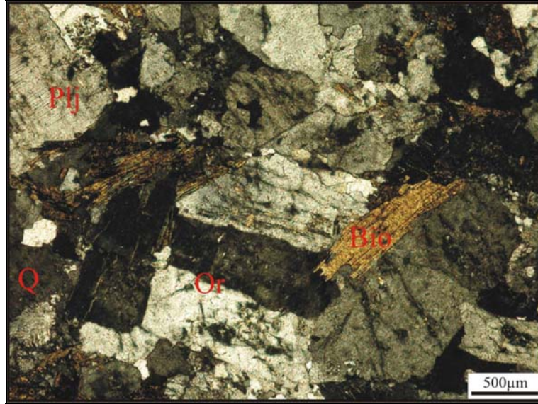
Şekil 4.27. Granit kayası içinde gözlenen mirmekitik doku. (Plj; plajioklas, Bio; Biyotit, Or; Ortoklaz, Q; Kuvars)
