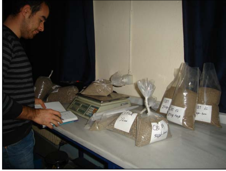
Şekil 3.12. Elek analizi sonrası paketlenmiş örneklerin hassas terazide tartım işlemi
