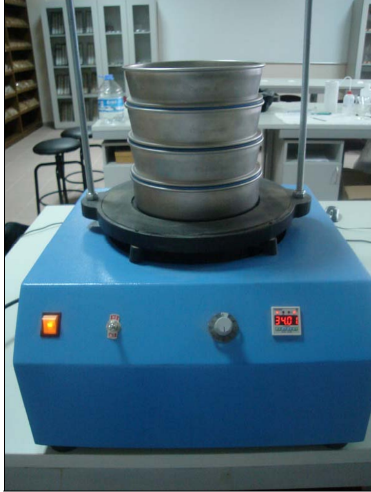
Şekil 3.10. Laboratuvarında kumların farklı tane boylarına ayrılmasında kullanılan elek seti ve vibrasyonlu elek makinesi.
