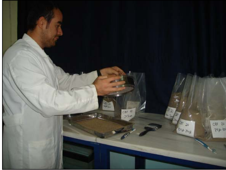
Şekil 3.11. Elek analizinde örneklerin paketlenmesi ve elek takımının temizlenmesi.
