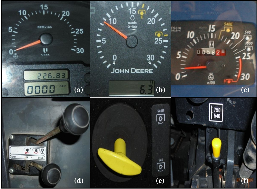
Şekil 3.12 540 devir/dakika ve 750 devir/dakika için kontrol elemanları ve devir göstergeleri
