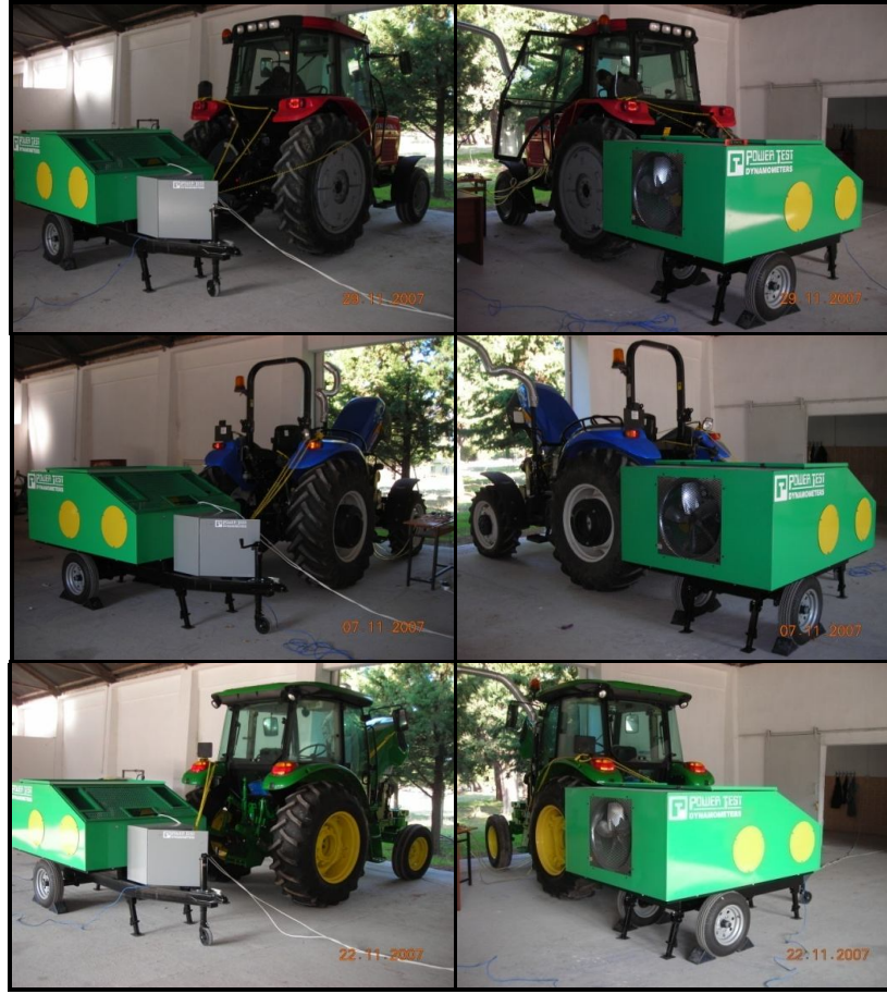
Şekil 3.11 Kuyruk mili dinamometresi ve test traktörlerine bağlantısı
