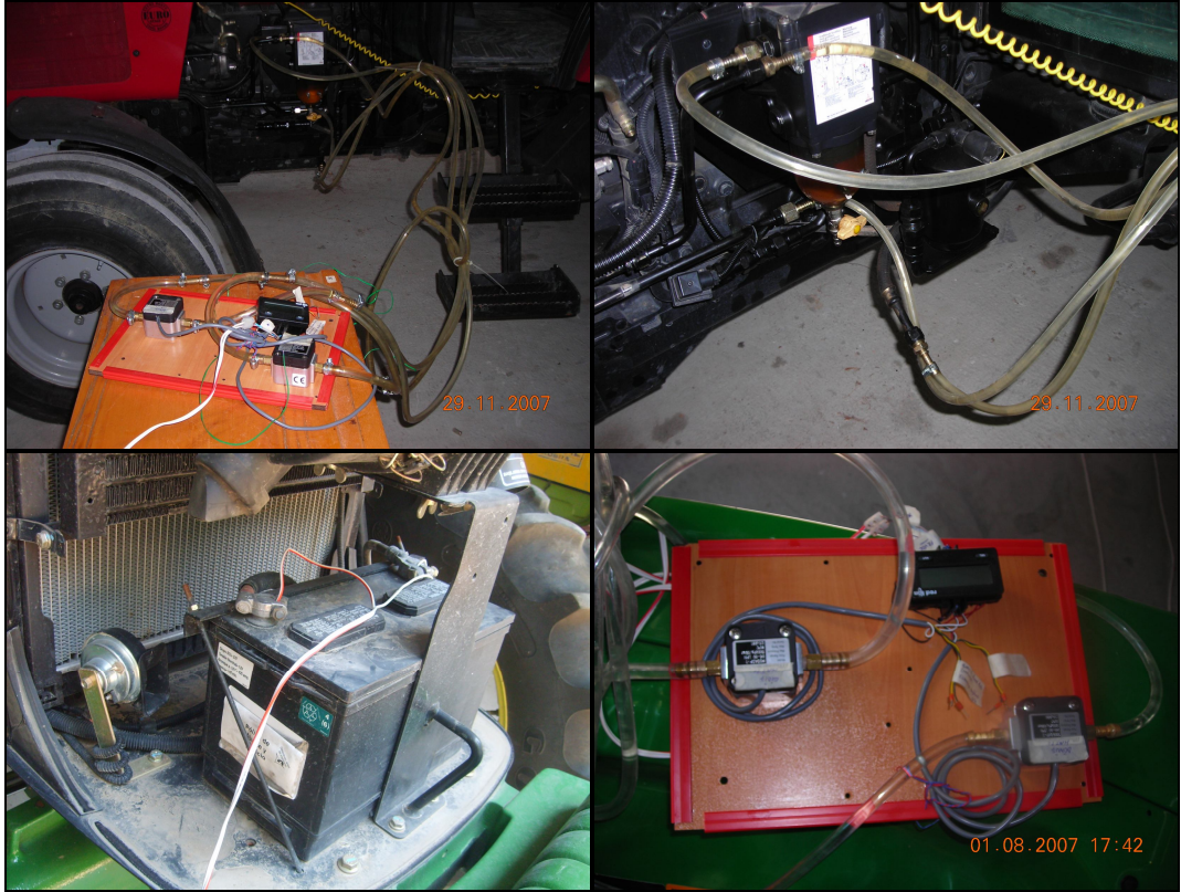
Şekil 3.7 Akışmetre ve yakıt tüketimi ölçüm sistemine montajı
