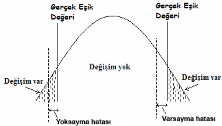
Şekil 6. Fark görüntülerine ait histogramdan, değişimlerin varlığını belirlerken eşik değerlerinin yanlış seçilmesi durumunda meydana gelen olası hatalar (Metternict, 1999 ; Jin ve Sader, 2005).
