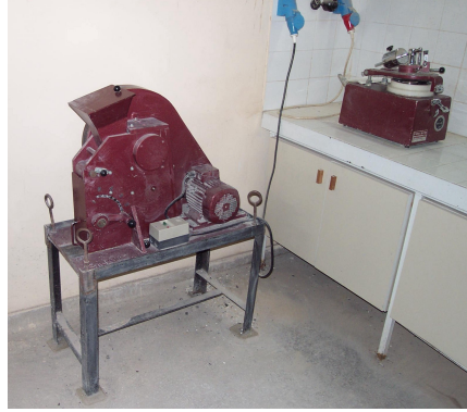
Şekil 2.2. Cumhuriyet Üniversitesi Jeoloji Mühendisliği Kırma-Öğütme laboratuvarındaki Fritsch marka çeneli kırıcı
