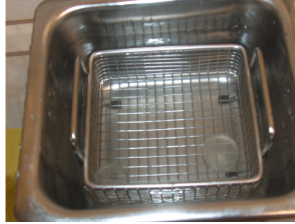
Şekil 2.23: Parlatma kalıplarının üzerlerindeki herhangi bir kirliliğe karşı ultrasonik banyoda yıkanması
