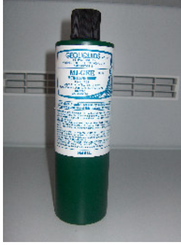
Şekil 2.16. Zirkon ve apatit minerallerinin birbirinden ayrımını sağlayan di-iodometan türü ağır sıvı özellikleri
