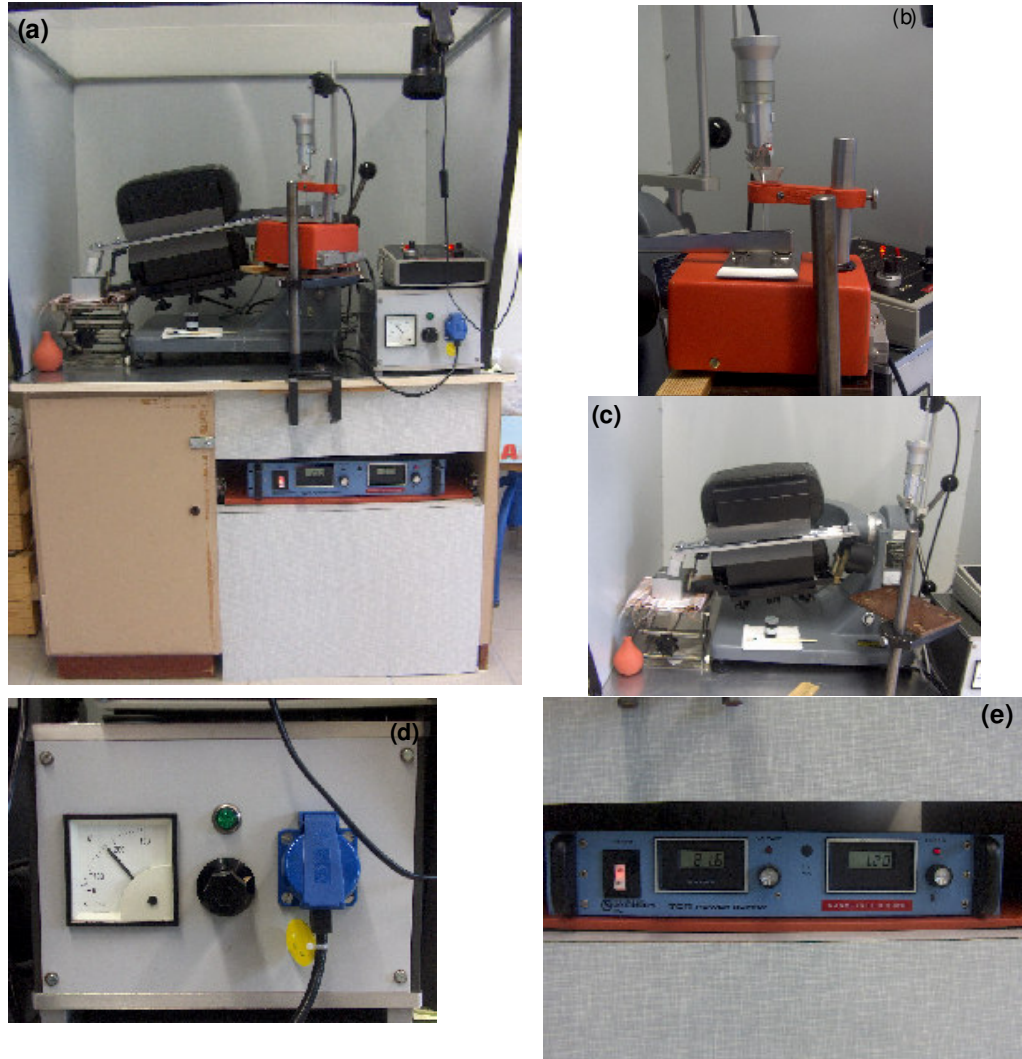
Şekil 2.14: Manyetik seperatörün (a) genel görünümü, (b) besleme alanı, (c) ayırım sahası, (d) voltmetre, (e) ampermetre
