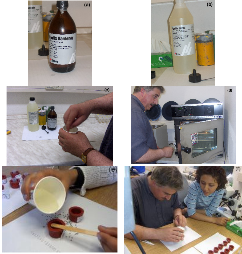
Şekil 2.21: Apatit minerallerinin epoksiye gömülmesi aşamalarında kullanılan (a) epokfix hardener, (b) epokfix resin, (c) birbirleri ile karışması, (d) etüvde bekletilmesi ve (e, f) kalıplar içerisine boşaltılması
