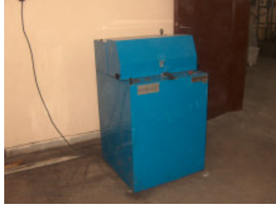
Şekil 2.3. Cumhuriyet Üniversitesi Maden Mühendisliği Cevher Hazırlama laboratuvarındaki Gy-Ro-Mill (Glen Creston) marka halkalı değirmen
