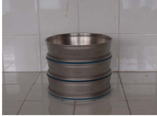
Şekil 2. 4. Apatit ve zirkon mineralleri ayrımı sırasında kullanılan 425 \mu\text{m} , 250 \mu\text{m} , 125 \mu\text{m} ' lik elek takımları.
