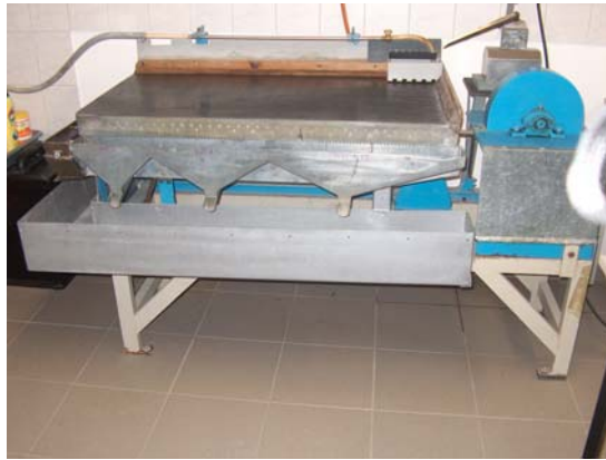
Şekil 2. 6. Technische Universität (T.U) Bergakademie Freiberg mineral ayırma laboratuvarlarındaki sallantılı masa.
