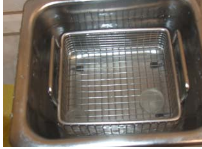
Şekil 2. 22. Parlatma kalıplarının üzerlerindeki herhangi bir kirliliğe karşı yıkanması.
