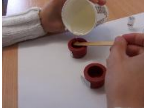
Şekil 2. 20. Hazırlanan epoksinin kalıplar içerisine boşaltılması.
