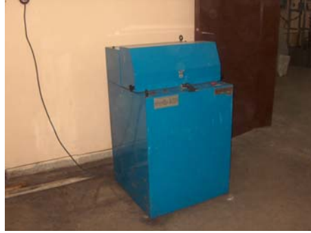
Şekil 2. 3. Cumhuriyet Üniversitesi Maden Mühendisliği cevher zenginleştirme laboratuvarındaki Gy-Ro-Mill (Glen Creston) marka halkalı değirmen.
