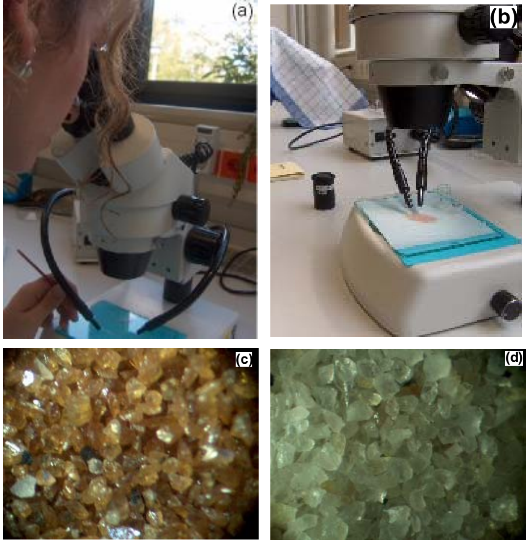
Şekil 2. 14. Manyetik seperatörde ayrımlanan minerallerin mikroskop altında incelenmesi ve titanit (x80 büyütme altında) ve apatit+zirkon (x80 büyütme altında) mineralleri.
