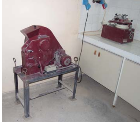
Şekil 2. 2. Cumhuriyet Üniversitesi Jeoloji Mühendisliği kırma-öğütme-eleme laboratuvarındaki Fritsch marka çeneli kırıcı.
