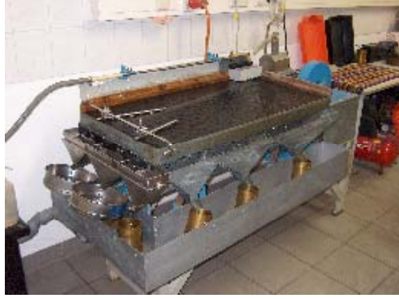
Şekil 2. 7. Sallantılı masa üzerinde tanelerin masanın sonuna doğru hareket edişi.
