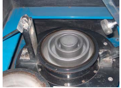
Şekil 2. 3. Cumhuriyet Üniversitesi Maden Mühendisliği cevher zenginleştirme laboratuvarındaki Gy-Ro-Mill (Glen Creston) marka halkalı değirmen.
