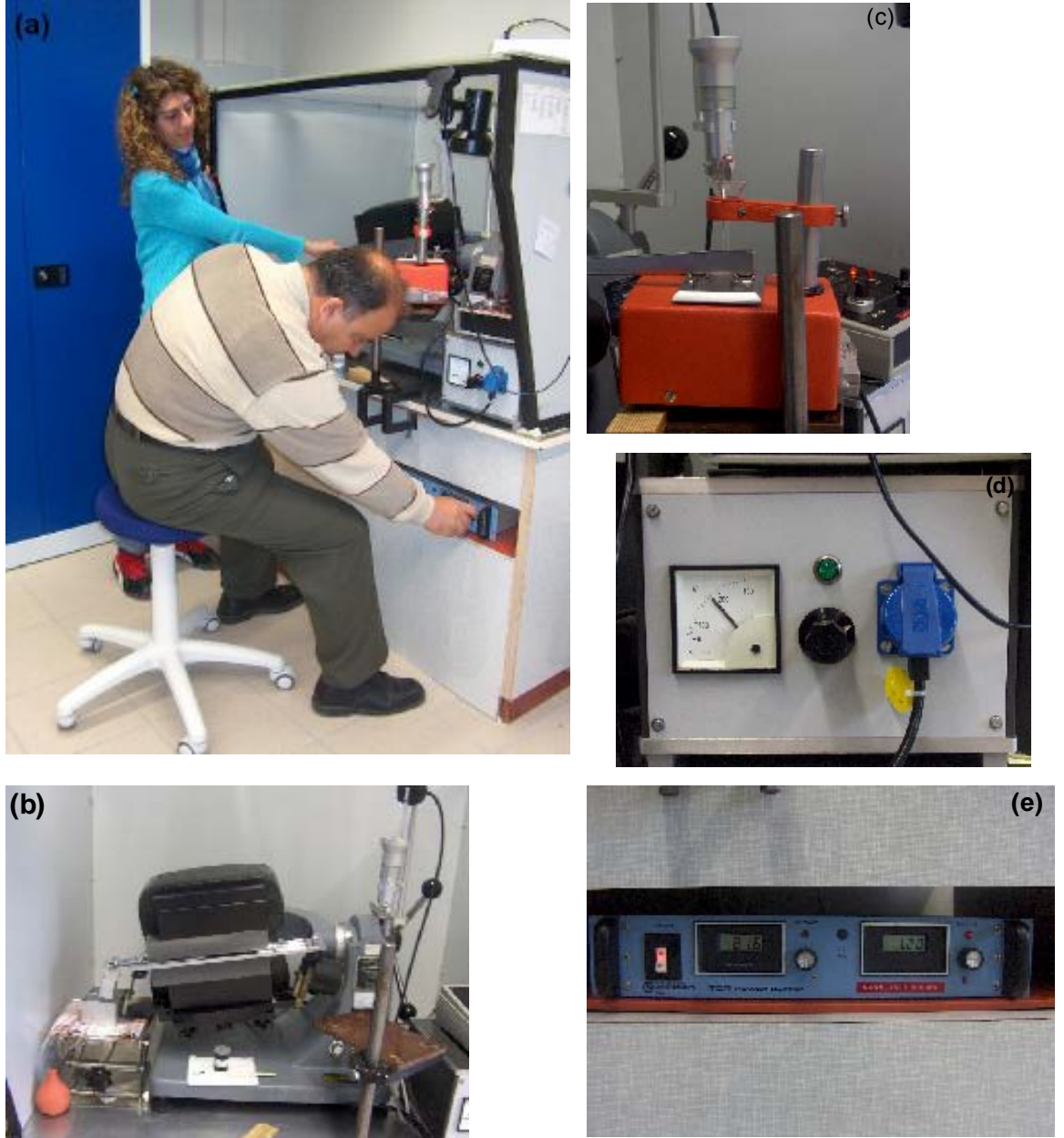
Şekil 2. 13. Technische Universität (T.U) Bergakademie Freiberg mineral ayırma laboratuvarlarında kullanılan manyetik seperatör ve bölümleri.
