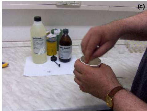
Şekil 2. 19. Sertleştirici (Epofix hardener) ve özel reçinenin (specific resin) karıştırılarak epoksinin hazırlanması (a, b, c) ve etüvde bekletilmesi (d).
