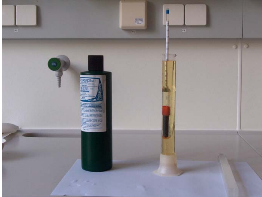
Şekil 2. 15. Diodometan yoğunluğunun kontrol edilmesi işlemi.
