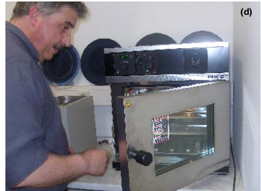
Şekil 2. 19. Sertleştirici (Epofix hardener) ve özel reçinenin (specific resin) karıştırılarak epoksinin hazırlanması (a, b, c) ve etüvde bekletilmesi (d).
