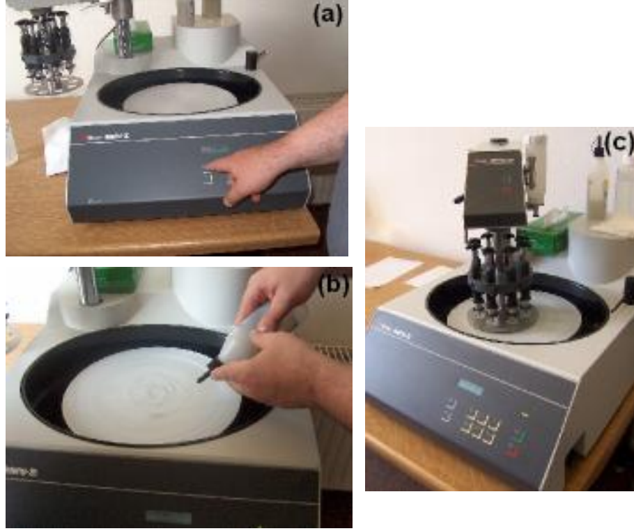
Şekil 2. 24. Struel Roto Pol RPM 130 marka susuz moda çalışan parlatma makinesi (a), aşındırma jelinin sürülmesi (b), parlatma kalıplarının yerleştirilmesi (c).
