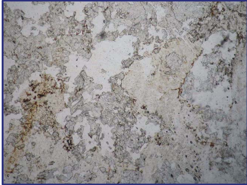
Şekil 25: Özşekilsiz sölestin minerallerinin mikro fotoğrafı. Örnek No: M16-4, Tek Nikol, Büyütme 5X.
