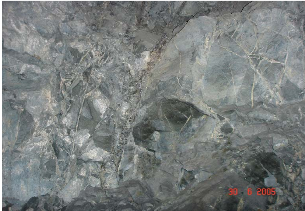
Şekil 3.4. Breşleşmiş yan kayaç parçaları ve/veya aglomera parçaları arasındaki boşluklarda kristallenmiş cevher ve gang mineralleri (sol kısım) ve yer yer gözlenen ağsı yapılı cevher damarcıkları (sağ kısım).
