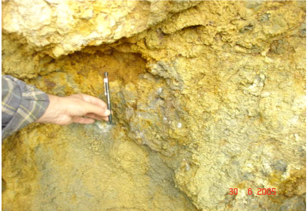
Şekil 3.2. Cevher damarlarının yüzeyde ileri derecede oksitlenmiş olarak görünüşü (D-2 Damarına yakından bakış)
