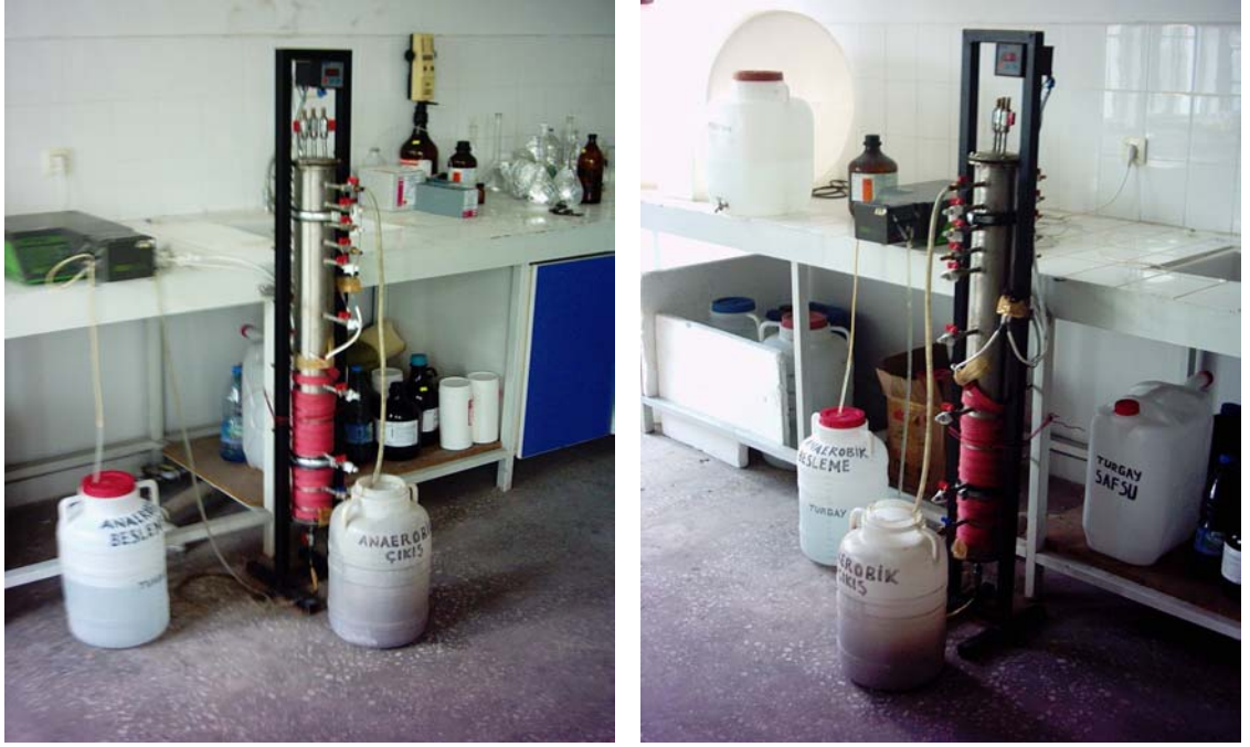
Şekil.3.1 Yukarı akışlı anaerobik çamur yatak (UASB) reaktörüne ait kesitler
