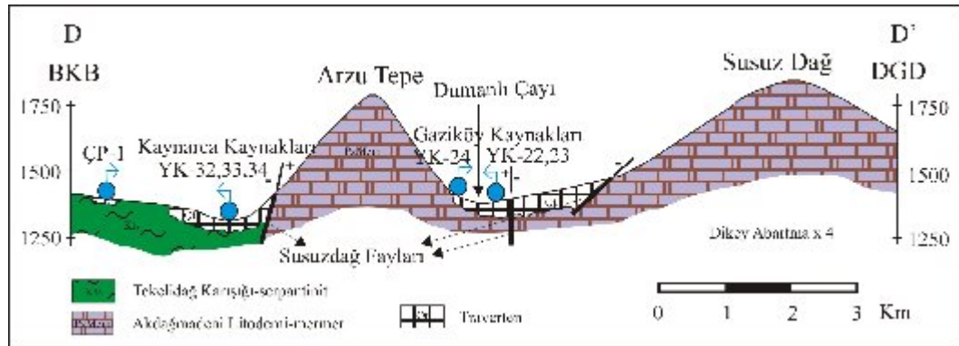
Şekil 4.4. Gaziköy (YK-22, 23, 24) ve Kaynarca (YK-32, 33, 34) kaynaklarının enine hidrojeolojik kesiti
