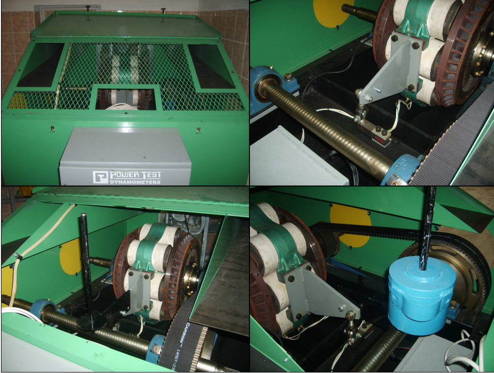
Şekil 3.11. Kuyruk mili dinamometresi kalibrasyonu.
