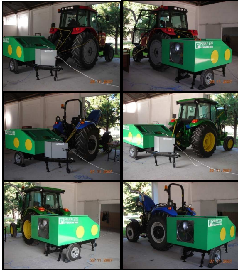
Şekil 3.12. Kuyruk mili dinamometresi ve test traktörlerine bağlantısı
