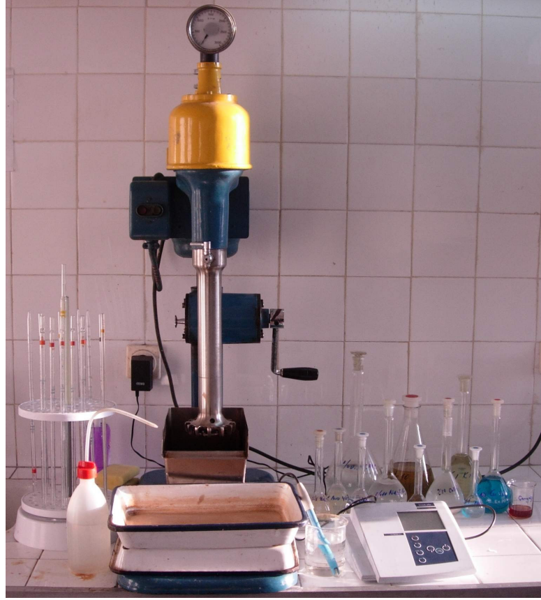
Şekil 3.7. Flotasyon deneylerinde kullanılan Denver tipi flotasyon makinesi
