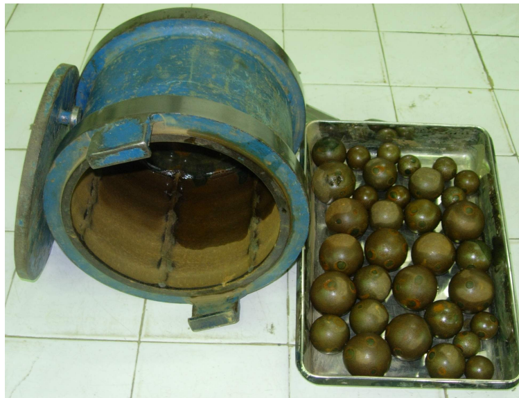
Şekil 3.8. Öğütme deneylerinde kullanılan çelik bilyalı değirmen ve bilyalar
