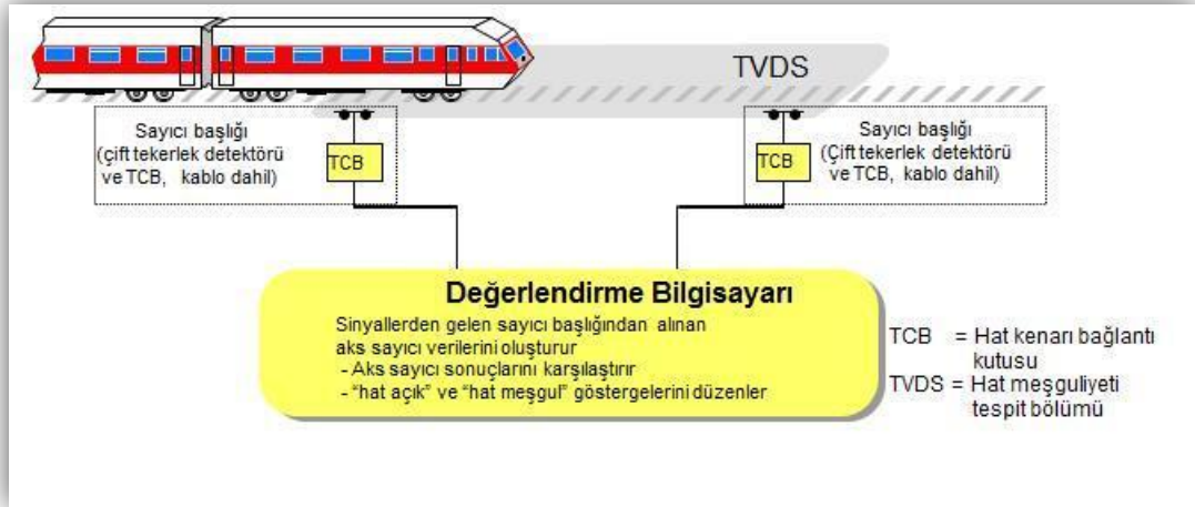
Şekil 3. 7: Aks Sayıclı Ray Devresinin Çalışma Prensibi
