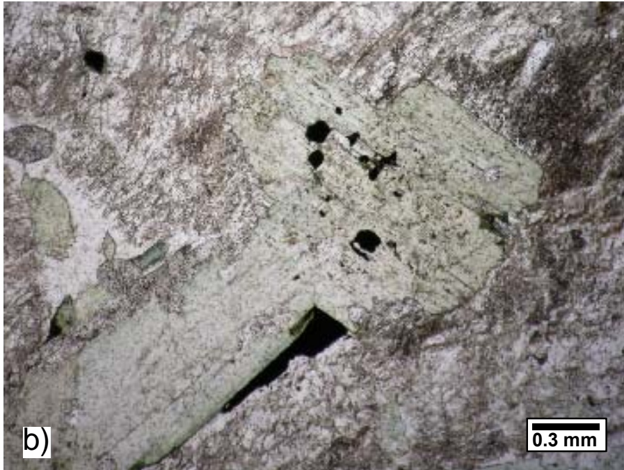
Şekil 6.3. Dededağ Dioriti' ne ait diyorit örneğindeki piroksen minerallerinden itibaren uralitleşme ile oluşan amfibol mineralinin a) çift nikoldeki, b) tek nikoldeki görünümü (VU-37 nolu örnek).
