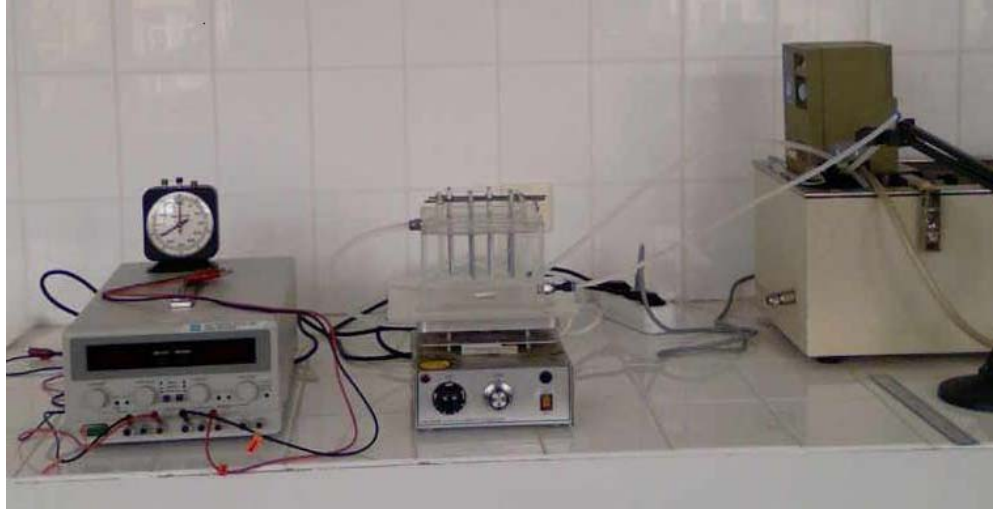
Şekil 4.3. Deneysel çalışmada kullanılan elektrokoagülasyon deney düzeneği görünüşü.
