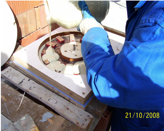
Şekil 33. Bobinlerin ve mıknatısların kalıp içersine alınması.
