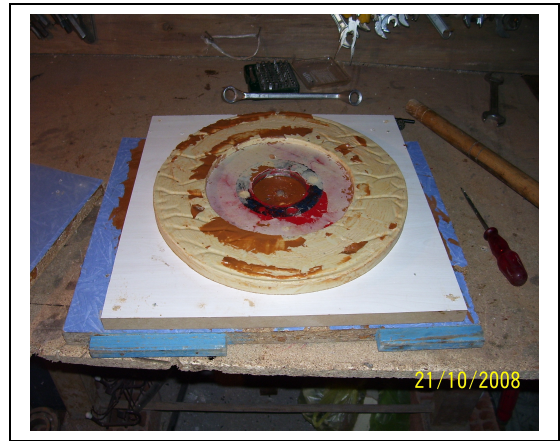
Şekil 33. Bobinlerin ve mıknatısların kalıp içersine alınması.
