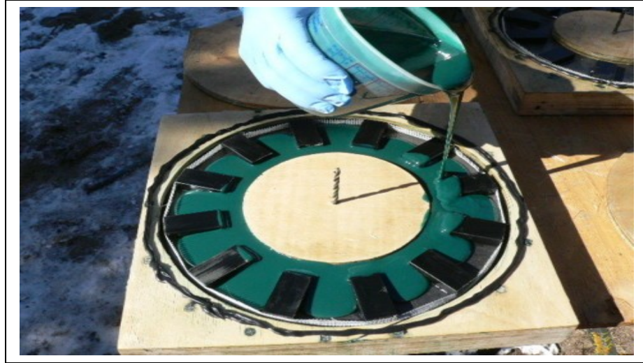
Şekil 23. Neodyum N35 mıknatısların arasının polyester ile doldurulması.
