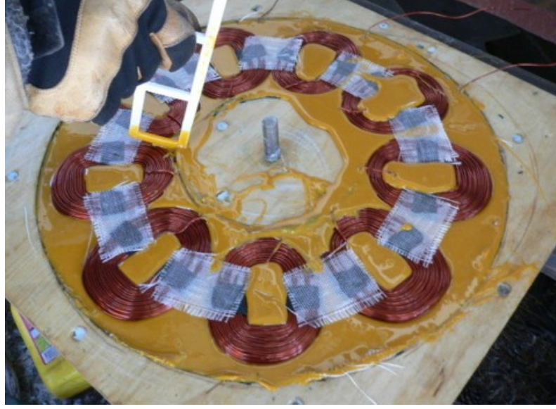
Şekil 32. 9 adet bobin sarımı yapıldıktan sonra kalıp içersine alımı (Banderet, Bartmann, Fink, 2009).
