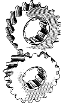
Şekil 2.2. Novikov profilli dişli çark çifti
