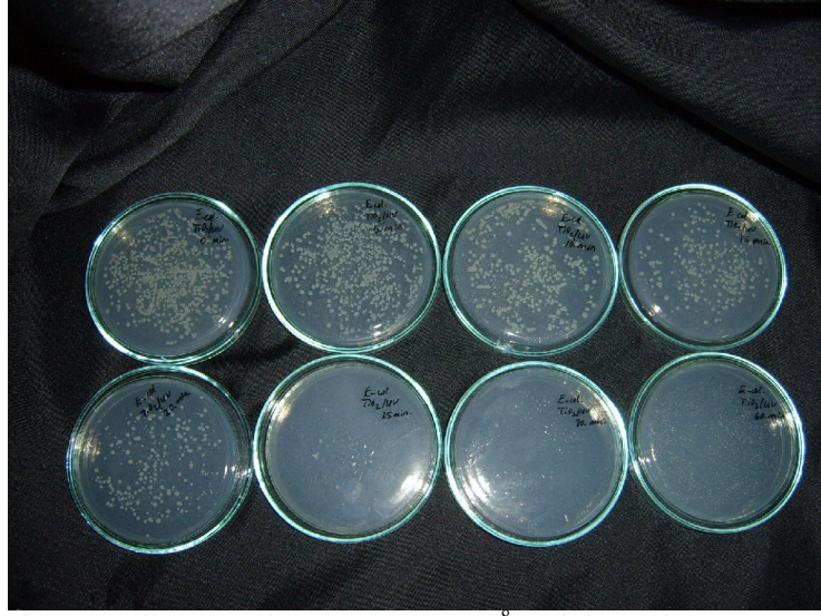
Şekil 3.2. Başlangıç mikroorganizma sayısı 1 \times 10^8 (cfu/mL) olan E-coli 'nin 0-60 dakika TiO_2/UV sistemi sonrasında alınan örneklerin seyreltme yapılmadan ekim yapılan petri tabakları
