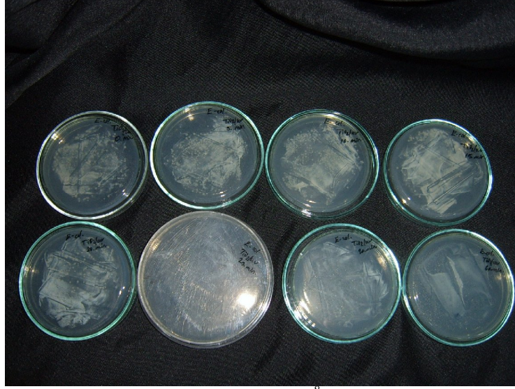
Şekil 3.3. Başlangıç mikroorganizma sayısı 1 \times 10^8 (cfu/mL) olan E-coli 'nin 0-60 dakika TiO 2 /UV ışınlaması sonrasında katı TiO 2 katalizöründen alınan örneklerden ekim yapılan petri tabakları
