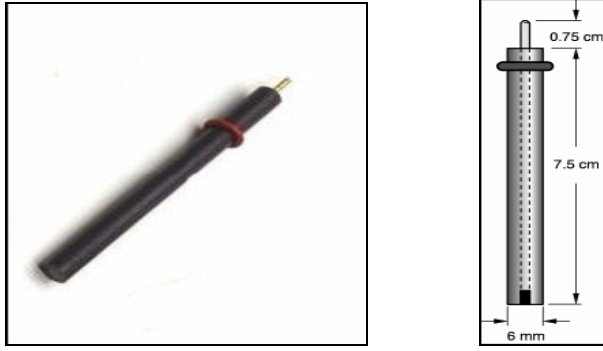
Şekil 2.5. Camsı karbon çalışma elektrodu.
