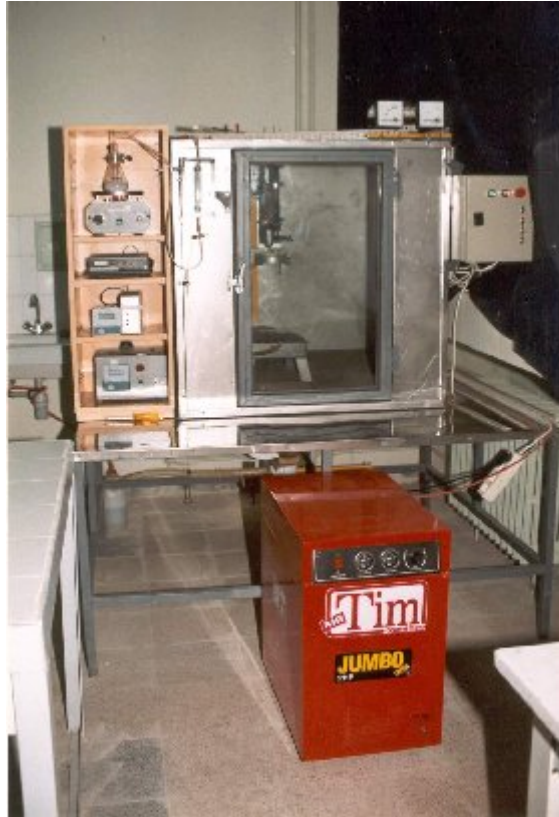
Şekil 3.2. Ultrasonik kimyasal püskürtme tekniğinin fotoğrafı.
