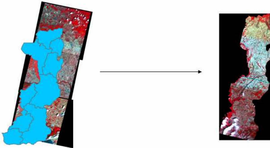
Şekil 6. Toprak sınırlanırının uydu görüntüsü üzerine aktarılarak çalışma alanını kesilmesi.
