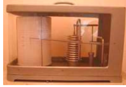
Fotoğraf 2. Hava basıncını ölçmek için kullanılan barometre ve barograf aygıtı
