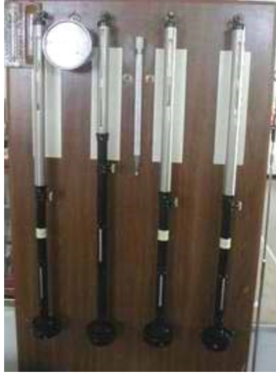
Fotoğraf 2. Hava basıncını ölçmek için kullanılan barometre ve barograf aygıtı
