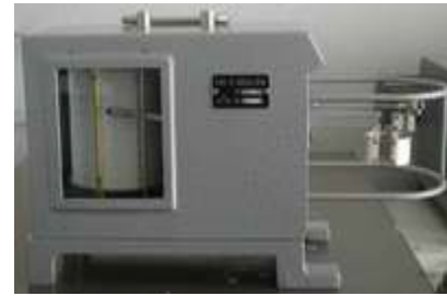
Fotoğraf 1. Hava sıcaklığını ölçmek için kullanılan termometre ve termograf aygıtı
