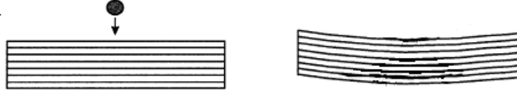
Şekil 4. 5. Düşük hızlı darbe yüküne maruz kalmış tabakalı kompozit malzeme.
