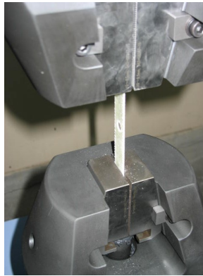
Şekil 6.1. Çekme cihazına bağlanmış numune.
