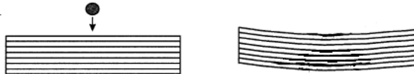
Şekil 4. 5. (tekrar) Düşük hızlı darbe yüküne maruz kalmış tabakalı kompozit malzeme.
