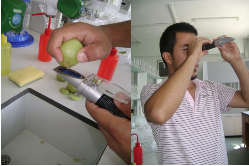
Şekil 10. El refraktometresi yardımı ile suda çözünebilir toplam kuru madde miktarı ölçümü.
