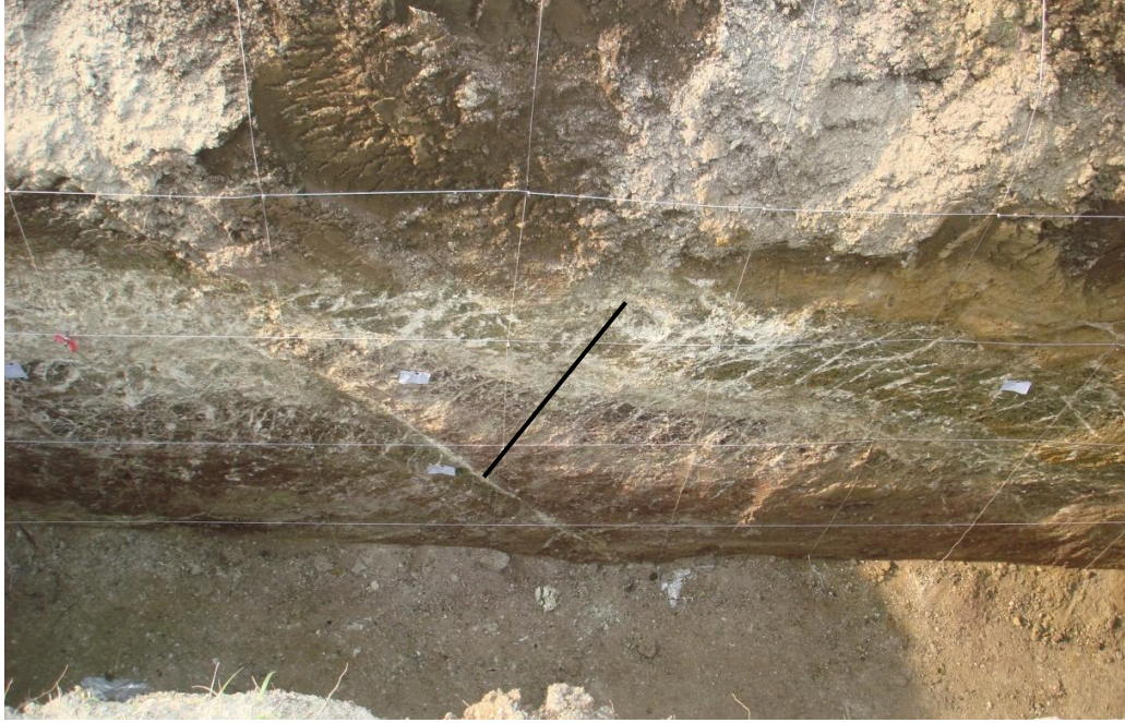
Şekil 49. Arıkaya Hendeği'nin doğu ve batı duvarı haritalama için gridlendikten sonra ters fayın ve buna antitetik ve ikincil olarak oluşan normal fayın görünümü.
