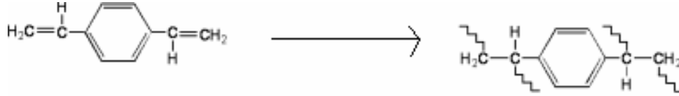
Şekil 2.1.4 DVB'in çapraz bağlanma mekanizması.
