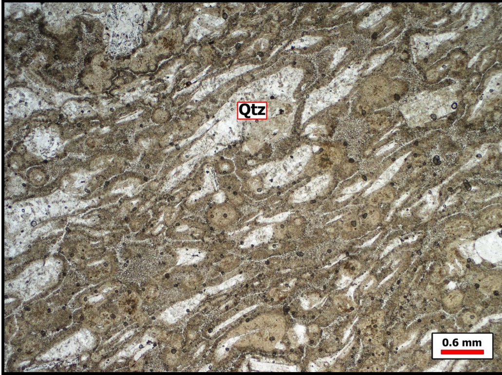
Şekil 4.23. Akma yapısına ait kesit görüntüsü. (2x objektif, //N) Qtz= Kuvars.
