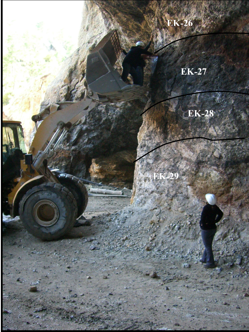
Şekil 4.76. Eskikişla Ocağı oda topuk galerisi 155 m. seviyesindeki 18 numaralı topukta görülen cevherleşme ve numune alma çalışmaları.
