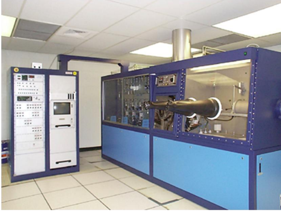
Şekil 3.3 Aixtron RF 200 MOCVD sistemi
