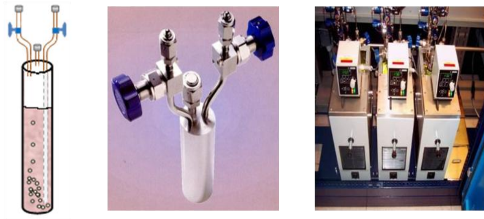
Őekil 3.6 Dip – tp giriři bulunduran, zel paslanmaz elikten yapılan tipik bir nkaynak muhafaza kabı (bubbler). En saėdaki fotoėrafta grldė zere, faal bir sistemde kullanılan bubbler'lar bir termal banyo ierisindedir. Bu banyo ile bubbler'ın sıcaklıėı hassas bir Őekilde ayarlanır.
