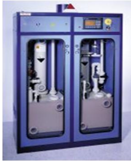
Şekil 3.17 Scrubber sistemi. Tehlikeli gazları yasal olarak belirlenen “güvenli konsantrasyon” sınırlarına kadar seyrelterek, etkisiz hale getirir.
