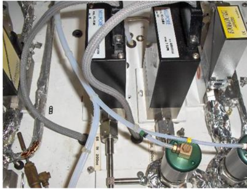
Şekil 3.7 Elektronik kütle-akış kontrolörü.
