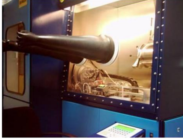
Şekil 3.5 Eldivenli kutu ( glove box ). Sistem açık havaya maruz bırakılmadan reaktör odasına giriş-çıkış işlemleri burada gerçekleştirilir.
