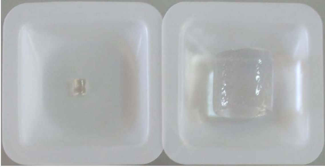
Şekil 2.3. Kuru ve şişmiş haldeki p(AMPS) hidrojellerinin dijital fotoğrafı.
