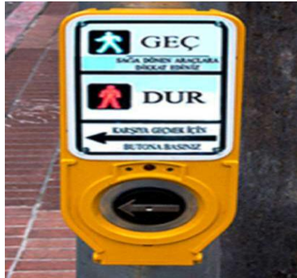
Şekil 26 - Pelikan yaya geçidinde yaya kumanda düğmesi örneği (TSE, TS 12576, 2012)
