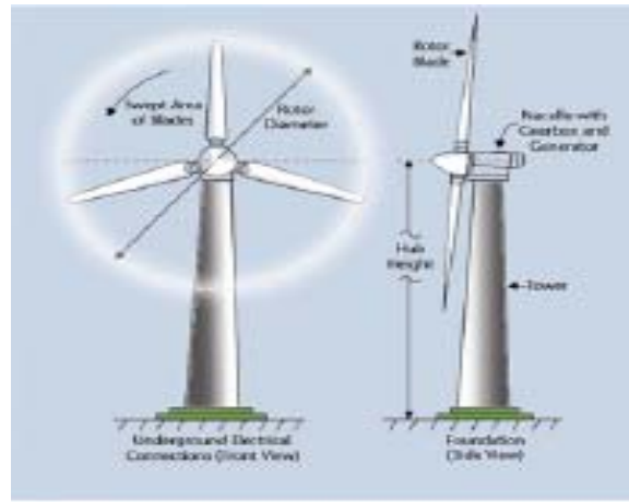
Şekil 4-2 Yatay Eksenli Rüzgâr Türbininin Çalışma Şeması
