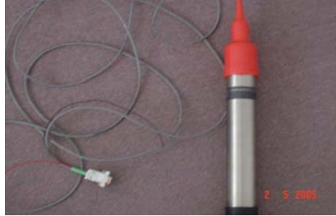
Şekil 11. Toprakta radon gazı ölçüm düzeneği
