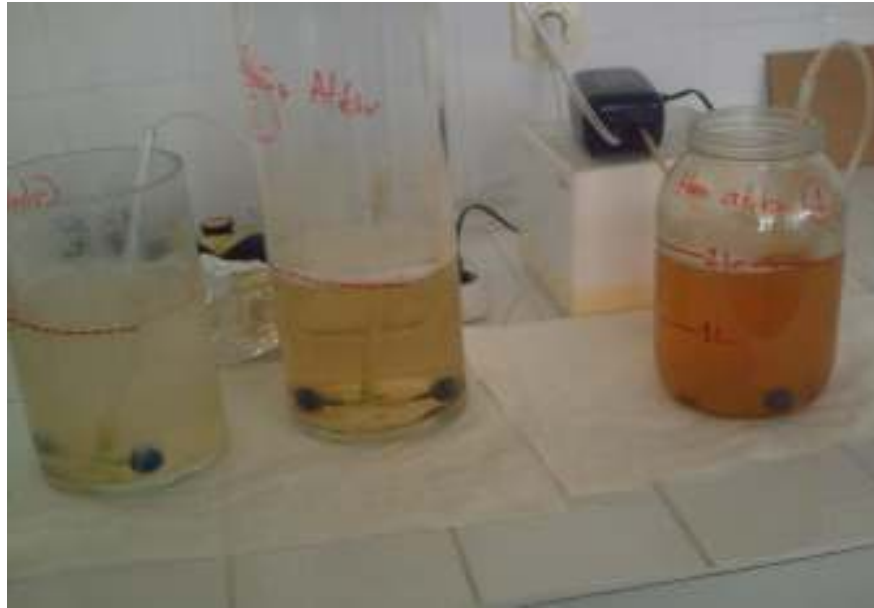
Şekil 5.2 Çözünmüş inert KOI'nin belirlenmesi için kullanılan kesikli aerobik reaktör sistemi.
