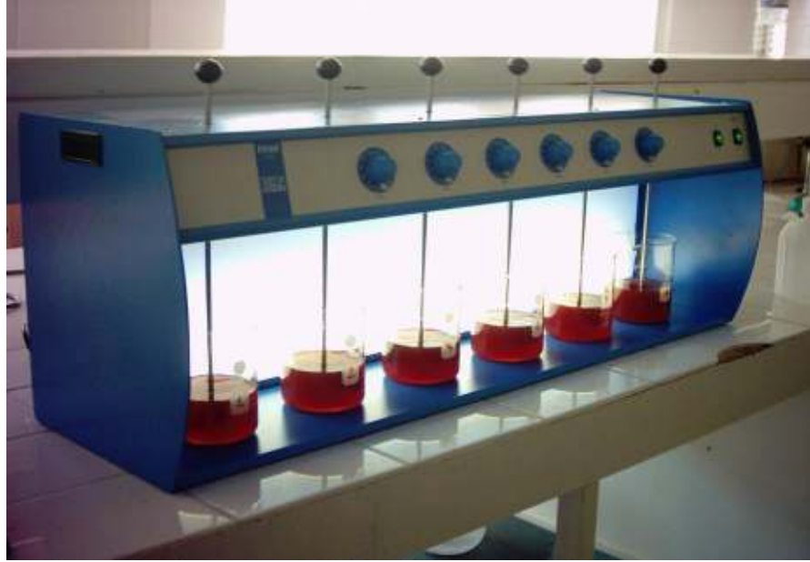
Şekil.5.1 Fenton prosesi çalışmalarında kullanılan jar testi düzeneği.
