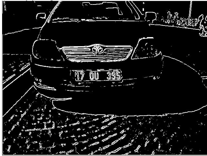
Şekil 4. Sobel operatörü kullanılarak araç görüntüsünden edilen “Yatay ve Dikey kenar” görüntüsü.
