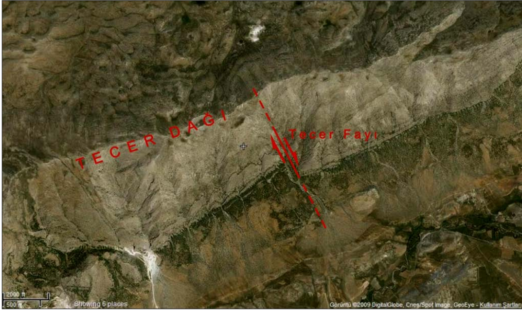
Şekil 3.11: İnceleme alanında gözlenen doğrultu atımlı sağ yanal Kayapınar Fayı'nın Google Earth' de gösterimi.
