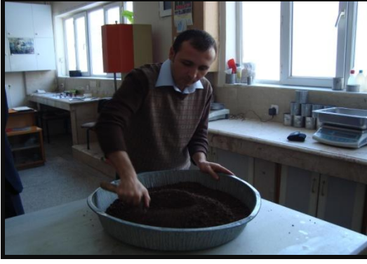
Şekil 5.2. Karışımların hazırlanması ve kompaksiyon
