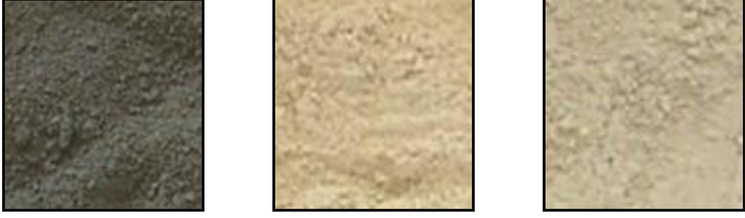
Şekil 2.1. Farklı renkteki uçucu küller
