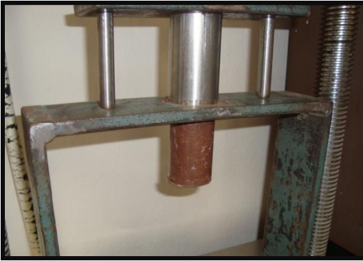
Şekil 5.3. 3.80-7.60 cm Boyutunda hazırlanan numuneler
