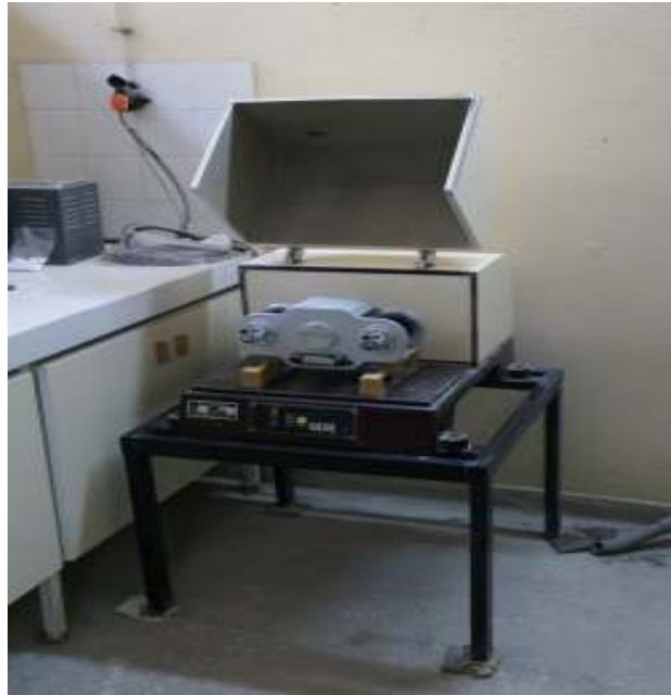
Şekil 2.1. Fritsch marka çeneli kırıcı'dan bir görünüm.
