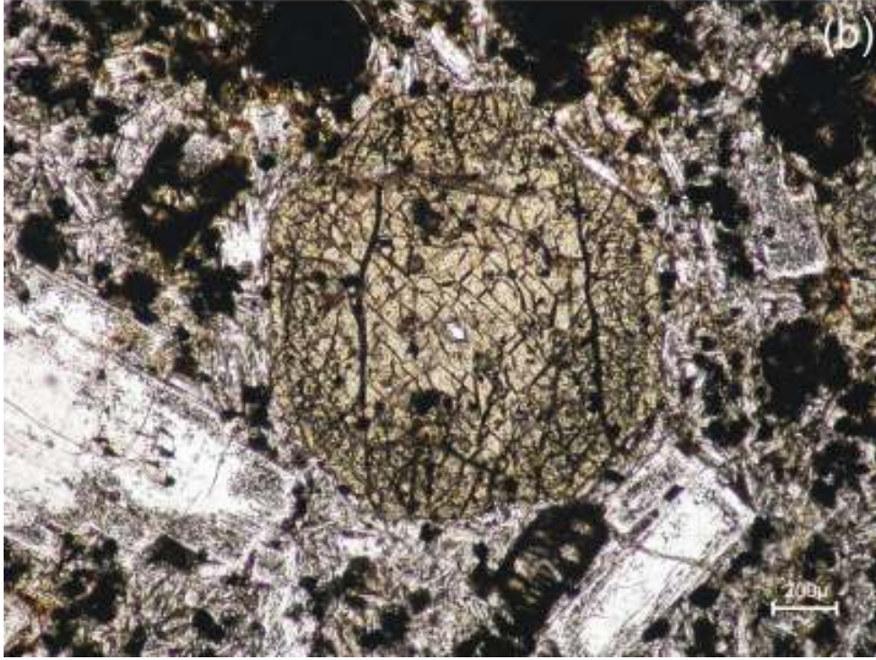
Şekil 3.17. Özşekilli ve çift yönde iyi gelişmiş dilinim izleri sunan ojit mineralinin a) çift nikol, b) tek nikol görünümü (SY-54 nolu örnekten alınmıştır.).
