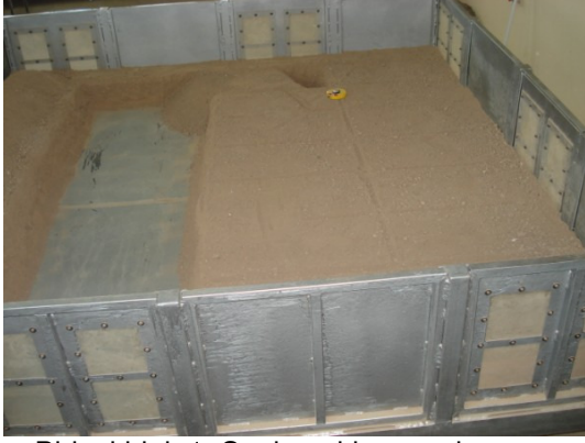
c. Birinci blok 1. Set kanal kazısından sonra
