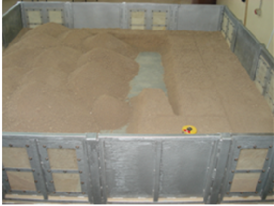
c. İkinci blok kazısı yapıldıktan sonra
