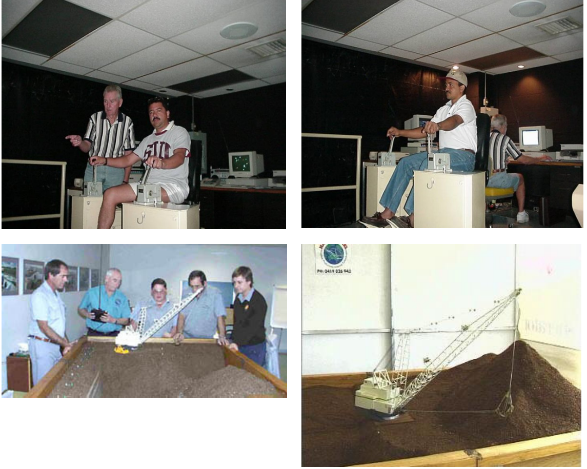
Şekil 2.2 DPT'deki çekme-kepçe modelleme havuzu ( http://members.ozemail.com.au/~hwinkel/modeltablepic.htm ; Erişim tarihi: 03.06.2009)
