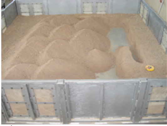
c. İkinci dilim kazısı yapıldıktan sonra
