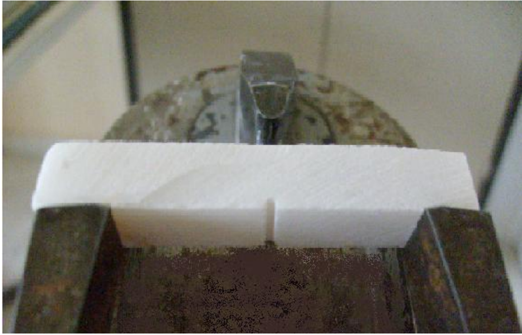
Şekil 4.6 Mesnetler üzerindeki numuneye çekiç vuruş pozisyonu
