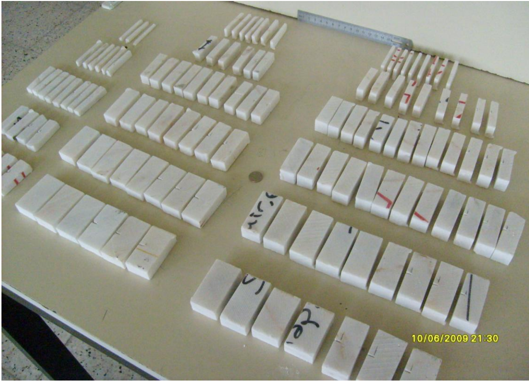
Şekil 4.7 Boyut çalışması için hazırlanmış çentikli ve çentiksiz mermer numuneleri
