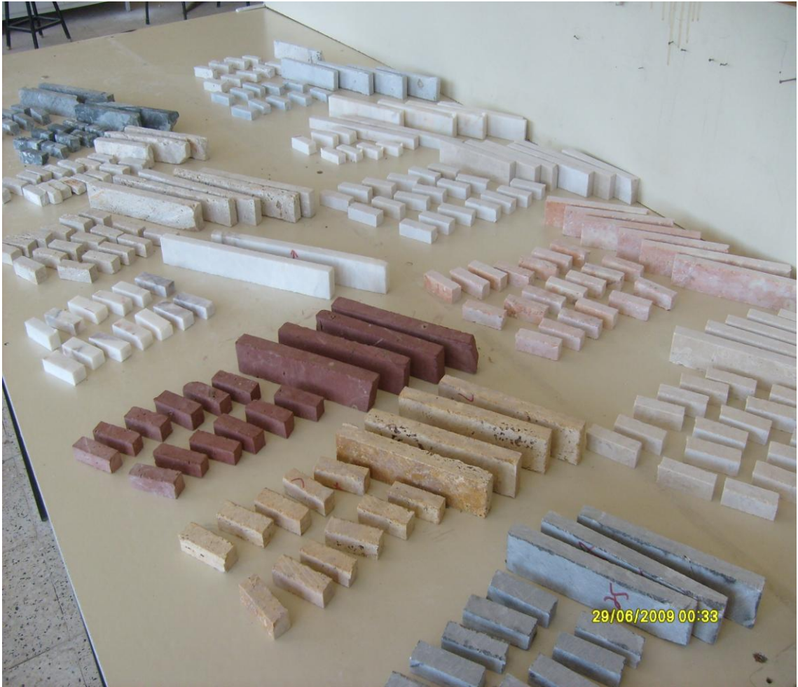
Şekil 4.12 Çentik darbe deneyi ve kırılma tokluğu deneyi numuneleri
