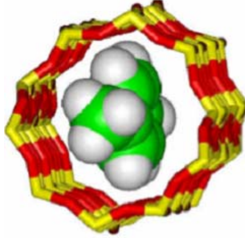
Sekil 1.9 Zeolitin Boşluklarına Sığabilecek Büyüklükteki Molekülleri Adsorplaması (Breck, 1974)
