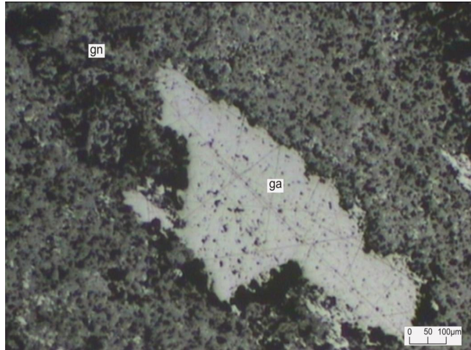
Şekil 3.20: Gang (kalsit) mineralleri (gn) tarafından ornatılmış galenitler (ga) (Örnek No: AD-7, Parlatma, TN, 5X).
