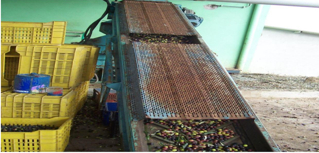
Resim 5. Taşıma bandı ile yıkama sistemine giden zeytinler (Orijinal, 2008).
