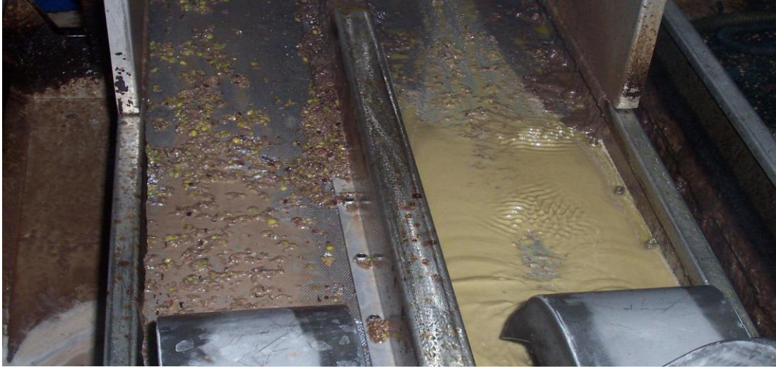
Resim 8. Pirina ve karasu + yağın ayrılması (Orijinal, 2008).
