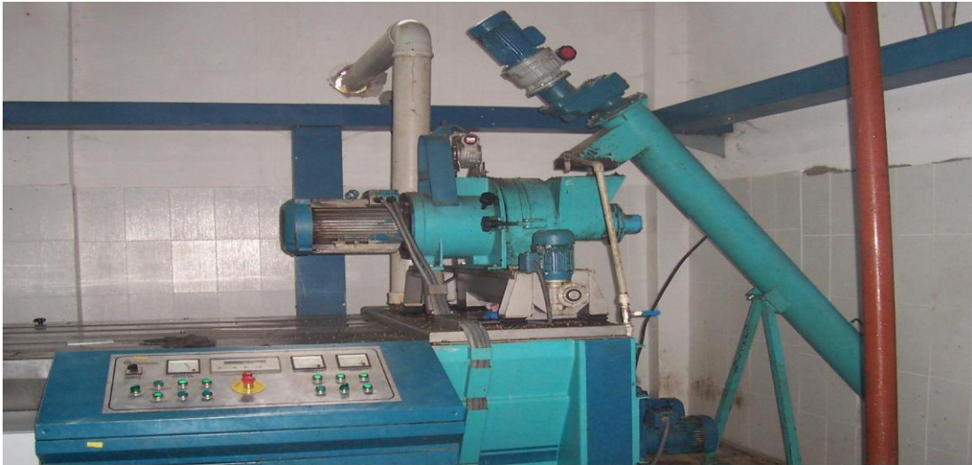
Resim 7. Zeytin yoğurma ünitesi (Orijinal, 2008).
