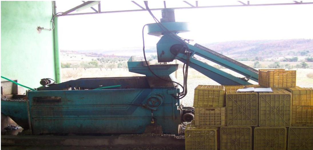
Resim 6. Zeytin yıkama sistemi (Orijinal, 2008).
